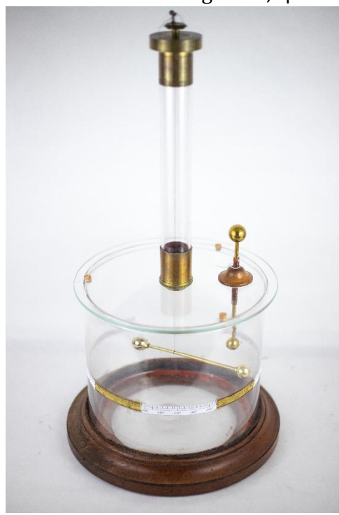
Figura 4.4. Balança de Coulomb de la Col·lecció d'Instruments Científics de la Facultat de Física de la Universitat de Barcelona (ca. 1850).
